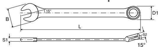
Самый распространенный и популярный тип гаечного ключа, считающийся в конструкции рожковый и накидной профили. Использование двух одномерных профилей делает инструмент универсальным по области применения. Ключи изготовлены из легированной стали в соответствии со стандартом DIN 3113, отвечают требованиям ГОСТ 16983-80.
