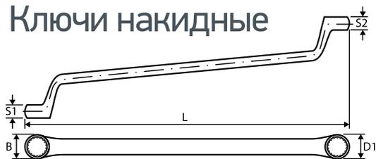
Применяются для работ с высоконагруженными соединениями. Изогнутая на 75°, коленчатая рабочая часть облегчает доступ в труднодоступные места. Ключи изготавливаются из легированной хромованадиевой стали по стандарту DIN 838, в соответствии с ГОСТ 2906-80.
