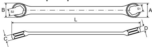
Сочетают в своей конструкции способность передавать высокие нагрузки, как накидной ключ, с удобством рожкового. Разрезные ключи применяются, в первую очередь для обслуживания штуцеров трубопроводов, когда использование рожкового ключа может повредить деталь, а применение торцевого или накидной головки невозможно. Инструменты производятся из хромованадиевой стали по стандарту DIN 3118 и соответствуют требованиям ГОСТ 10112-2001 по размерному ряду.
