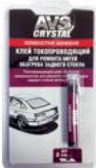
Токопроводящий клей на никеле предназначен для ремонта нитей обогрева заднего стекла автомобиля с повреждениями (разрывами) не более двух сантиметров. Не подлежат ремонту токопроводящим клеем подводящие напряжение шины.
