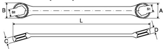
Сочетают в своей конструкции способность передавать высокие нагрузки, как накидной ключ, с удобством рожкового. Разрезные ключи применяются, в первую очередь для обслуживания штуцеров трубопроводов, когда использование рожкового ключа может повредить деталь, а применение торцевого или накидной головки невозможно. Инструменты производятся из хромованадиевой стали по стандарту DIN 3118 и соответствуют требованиям ГОСТ 10112-2001 по размерному ряду.
