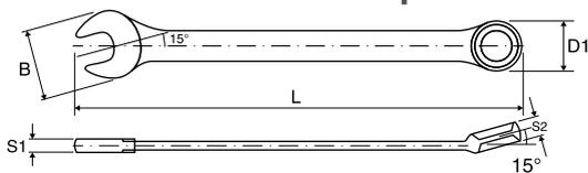
Самый распространенный и популярный тип гаечного ключа, считающийся в конструкции рожковый и накидной профили. Использование двух одноразмерных профилей делает инструмент универсальным по области применения. Ключи изготовлены из легированной стали в соответствии со стандартом DIN 3113, отвечают требованиям ГОСТ 16983-80.
